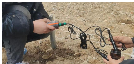
2#地下水采样点位洗井
