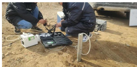
3#地下水采样点位洗井
