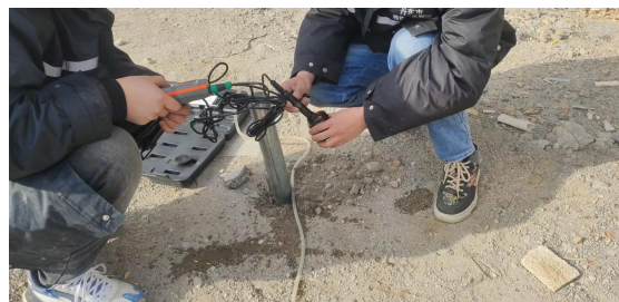
1#地下水采样点位洗井
